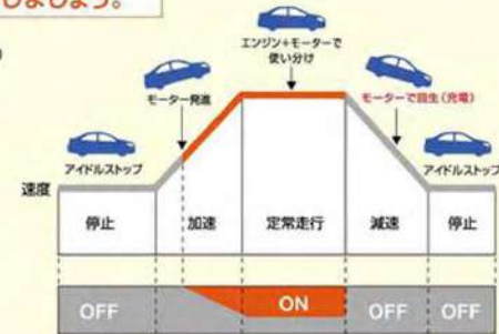
ハイブリッド車のエンジンの稼働図 （できるだけエンジンがかからない運転をしましょう）
