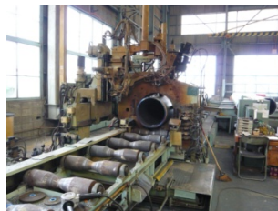
② 組立てに合うサイズに鋼管を切断
