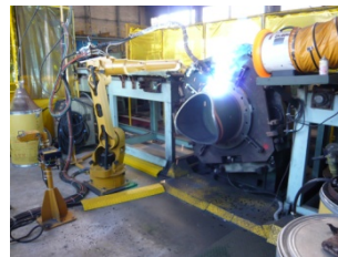
③ 溶接ロボットによる溶接状況
