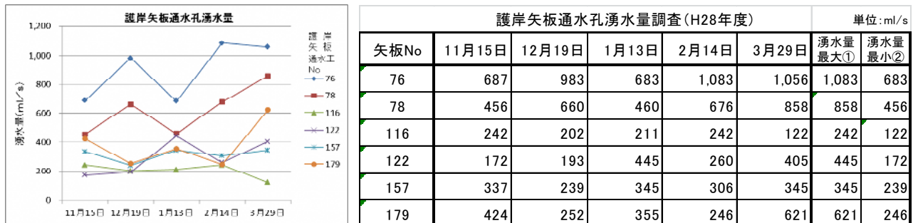
図2-(2)-24 護岸矢板通水孔の湧水量調査結果（京都府南丹土木事務所）
