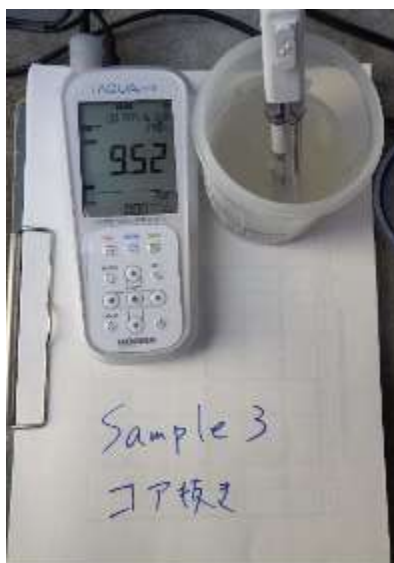
【写 3-1-10 コア抜き水 pH 測定】 pH 9.52
