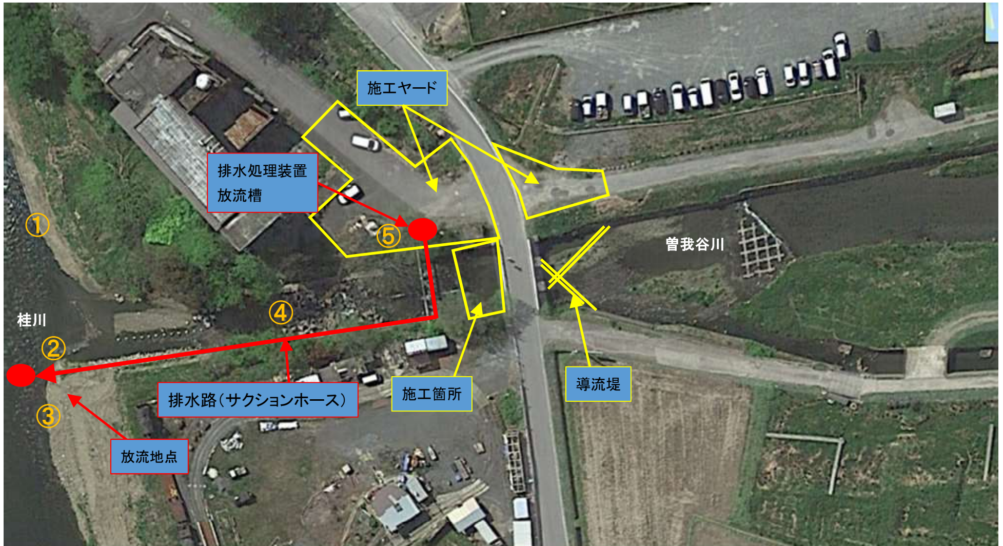
【図 3-1-7 処理水放流要領図 撮影日 H30. 4. 20 業者資料より】
