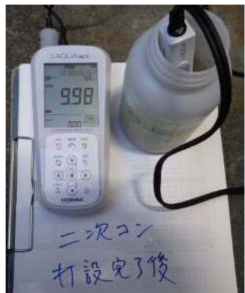
【写 3-1-11 二次コン打設時 pH 測定】 pH 9.98
