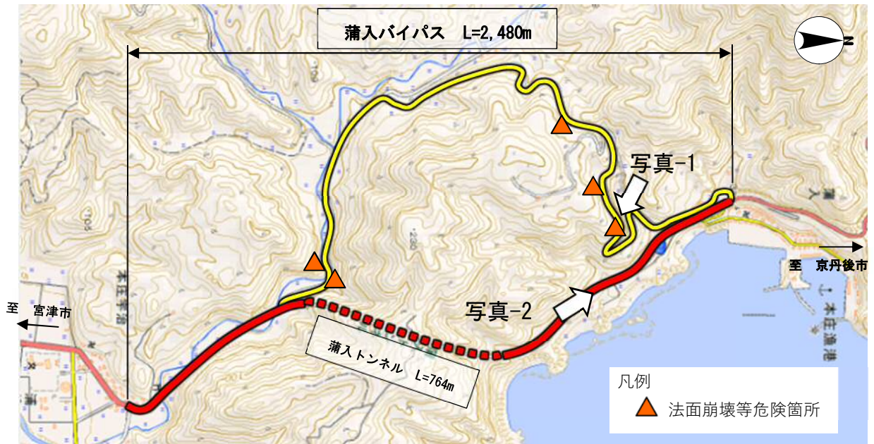
図-3 蒲入バイパスと法面崩壊等危険箇所の位置関係
