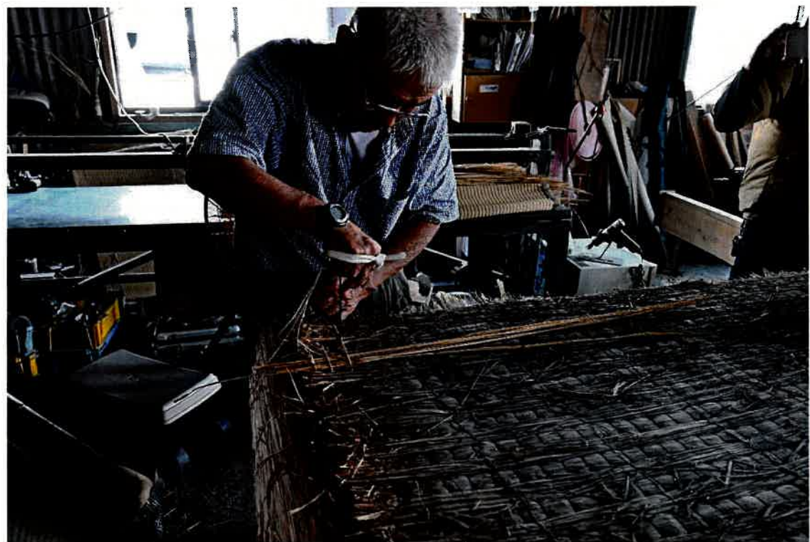
畳床補修中の状況
