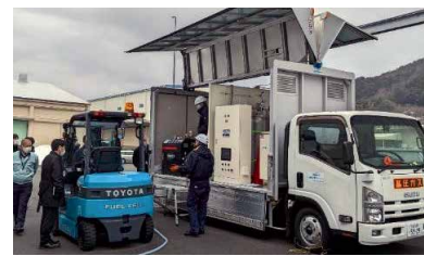
水素で動く燃料電池フォークリフト(FCFL)・移動式水素ステーション
