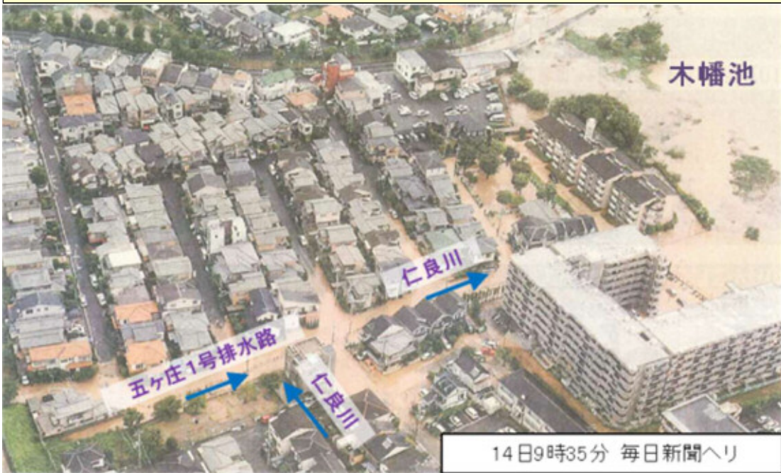
欠壊した弥陀次郎川の左岸からの氾濫流が弥陀次郎川の水路橋下部(五ヶ庄1号排水路)を流下し木幡池(南池)に流入
