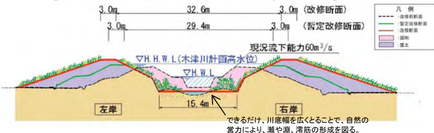
【計画横断図(要整備区間: 石部川合流点～京内橋区間)】
