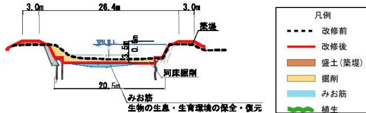
図- 3 大谷川改修計画断面図
