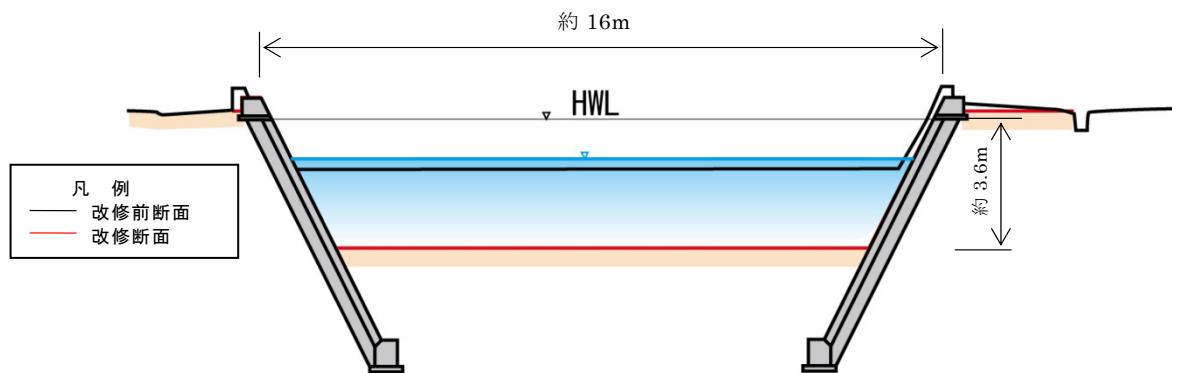
図 2-4 高野川の標準横断図 (1.40k)
