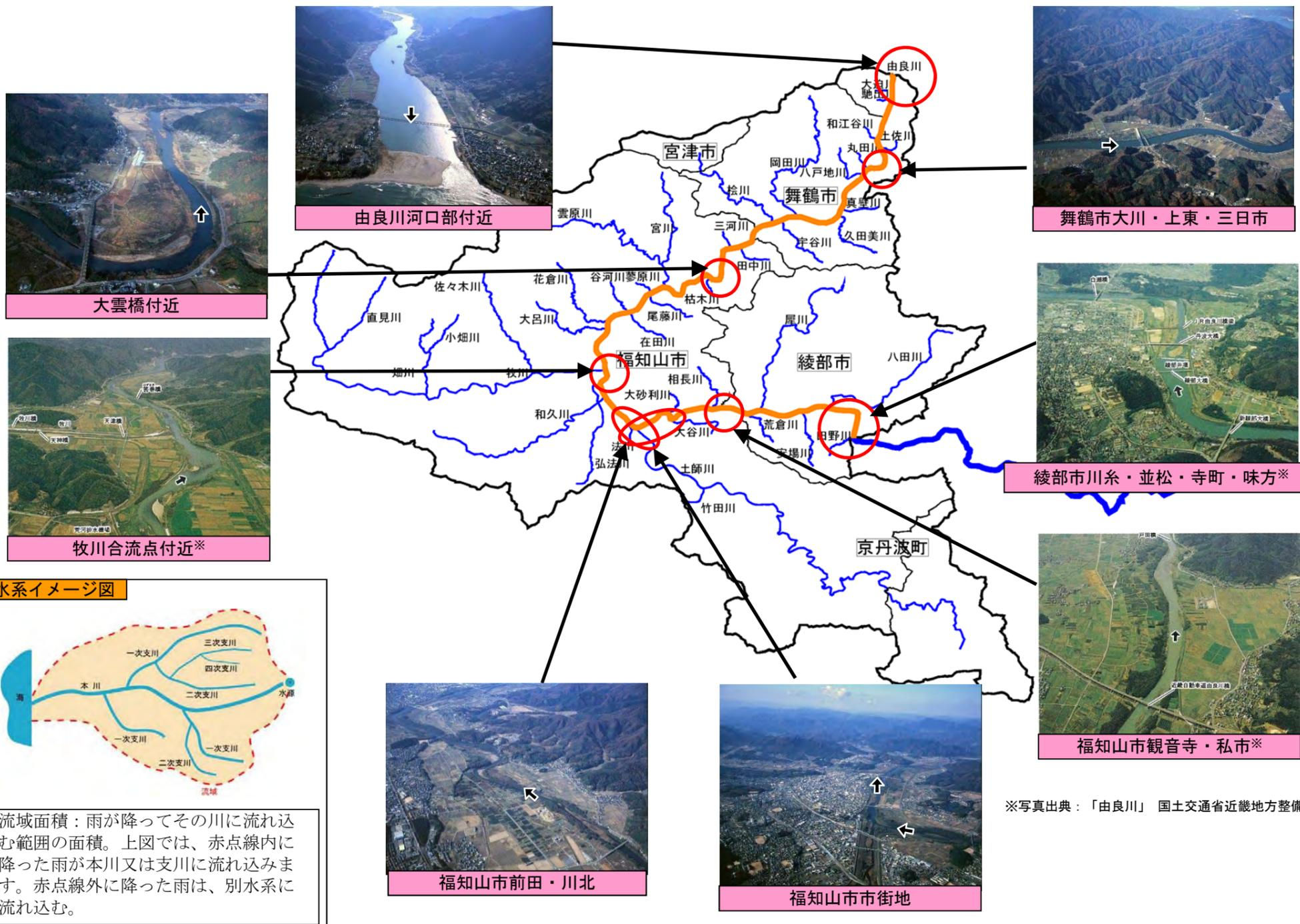
**流域面積**：雨が降ってその川に流れ込む範囲の面積。上図では、赤点線内に降った雨が本川又は支川に流れ込みます。赤点線外に降った雨は、別水系に流れ込む。
