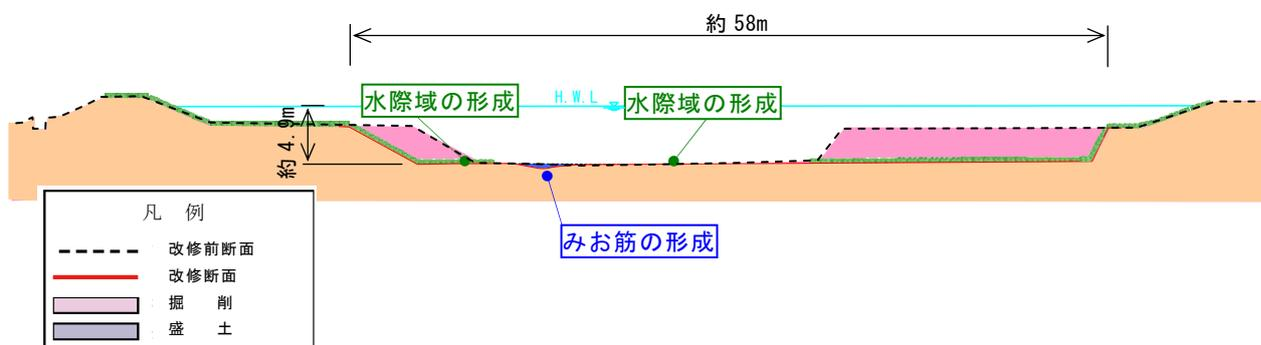
図 2-3 竹野川の標準横断面図 (6.0k)
