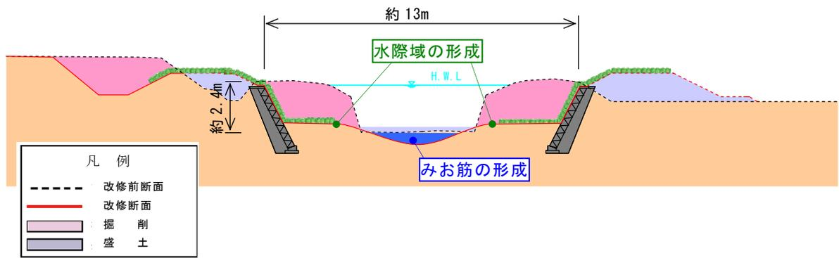
図 2-6 小西川の標準横断面図（整備区間①）
