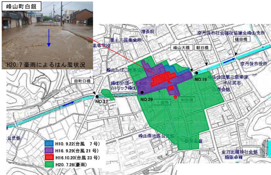
図 1-7 浸水被害の状況（小西川、近年洪水）
