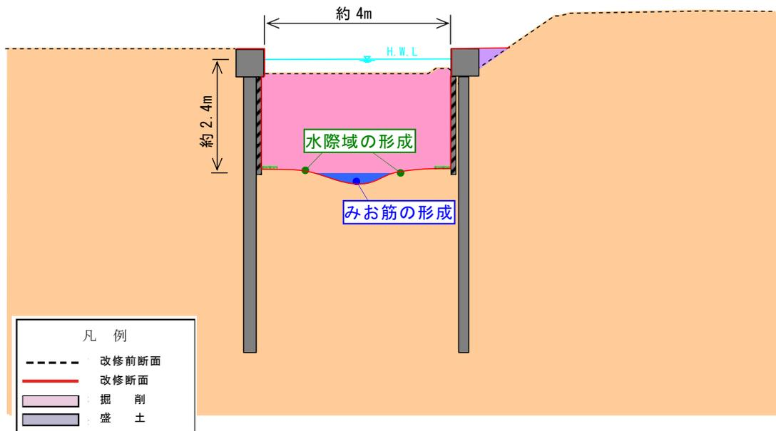
図 2-10 鳥取川の標準横断面図
