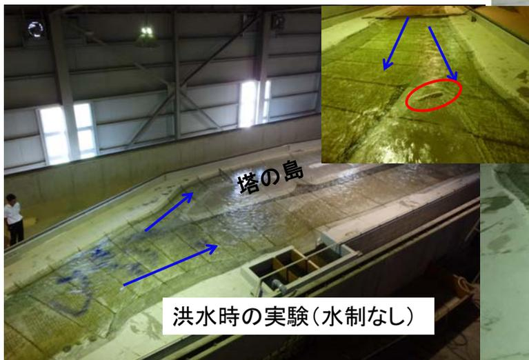
洪水時の実験(水制なし)
