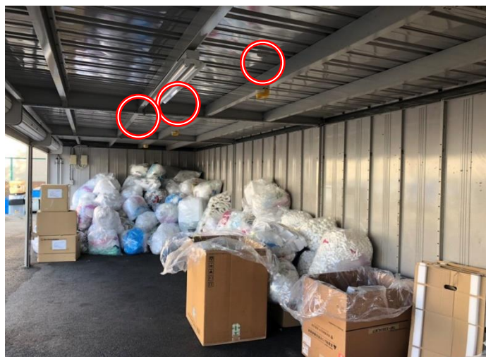
スマートセンサーを天井に設置し廃棄物の堆積状況をモニタリングする様子
