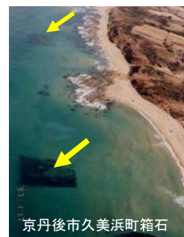
図 1-5-10 景観を妨げない施設【潜堤】
