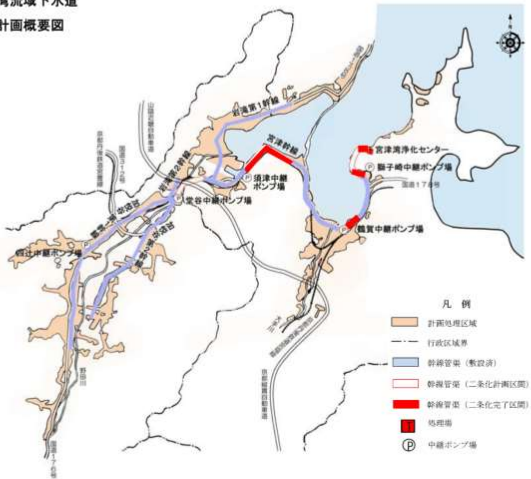
図 2.5 宮津湾流域下水道 汚水計画概要図
