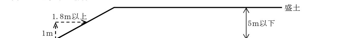
高さが5m超の場合、全てののり面で垂直1mに対する水平距離が2m以上の勾配
