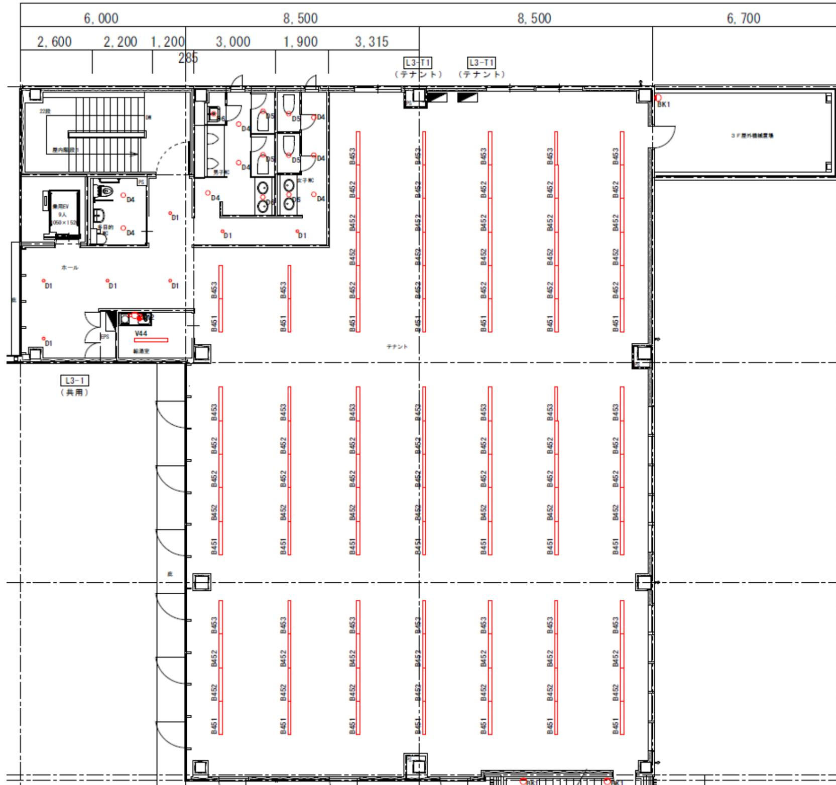
機器配置図(3階 空調設備図)
