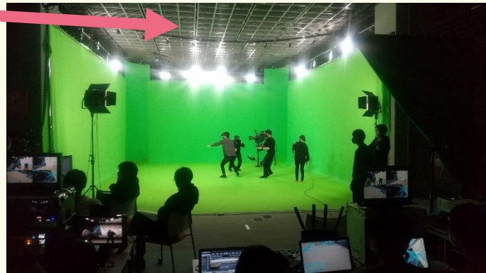
天井に備えられた300個のマーカ―を通じて、センサー付きカメラの位置を把握可能
