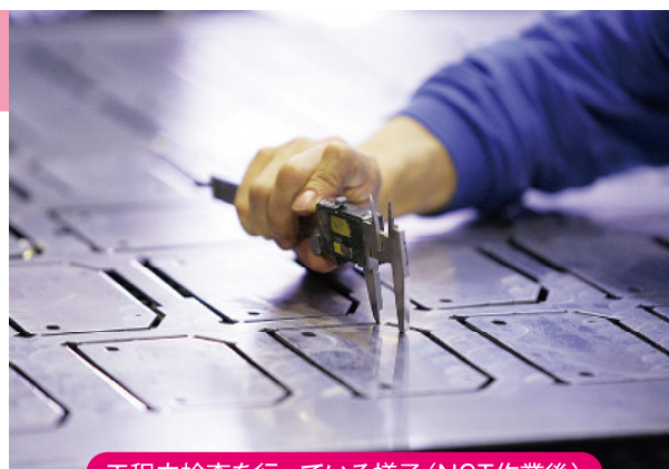
工程内検査を行っている様子(NCT作業後)
