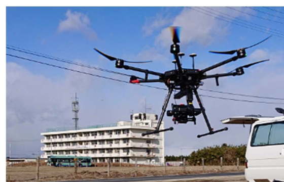
8Kカメラ搭載ドローン
