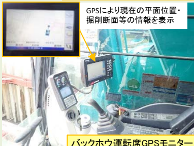
バックホウ運転席GPSモニター
