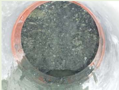
▲ 地下約25mの地盤状況
