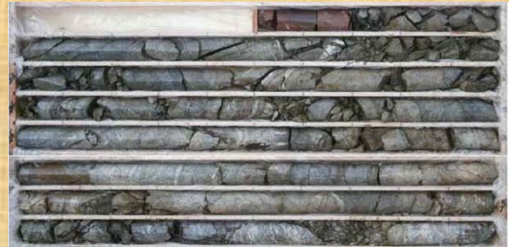
事前土質調査による岩盤層のコア (チャート)
