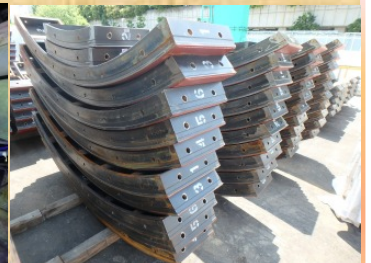
鋼製セグメント （曲線部トンネル部材）
