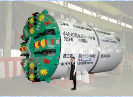
シールドマシンの工場の状況①
