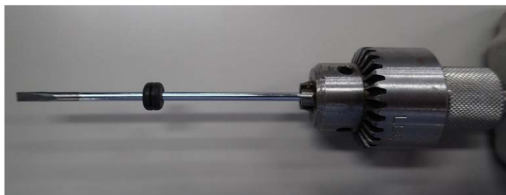
図-32 ドライバーの軸にゴムリングを装着することにより貫入深の読み取りを効率化できる
