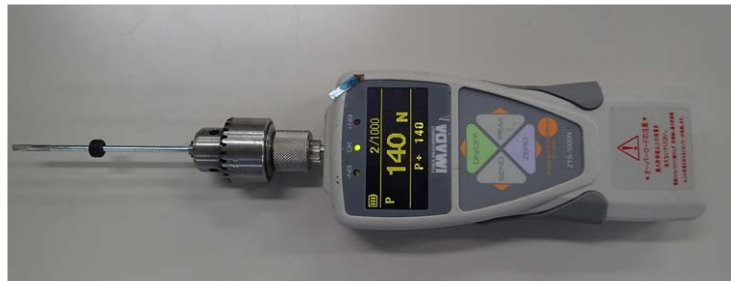
図-31 計測機器の例；デジタルフォースゲージ ZTS-1000N
