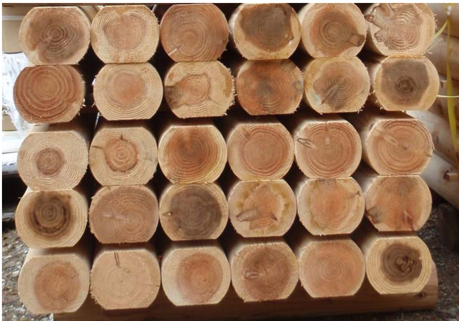
図-24 丸棒加工後、たいこ挽きしたスギの心材率の違い（赤茶色の部分が心材部）
