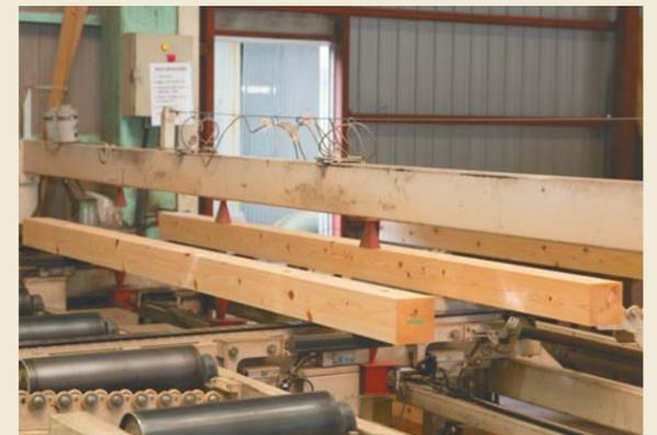
「JAS機械等級区分製材品」とは、強度と相関のある曲げヤング係数を機械で測定し、その値から等級格付けした構造材のことです。JAS法による厳しい品質基準があり、その品質表示が義務づけられているため、強度、含水率などの木材の品質・性能を知ることができます。
