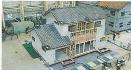
※阪神淡路大震災の最大級の地震動を再現し、建物各部への影響を測定しました。
