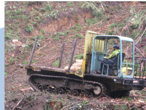
林内作業車によりコンテナ苗を運搬
