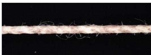
図 4 No.5 の摩耗試験後の様子
