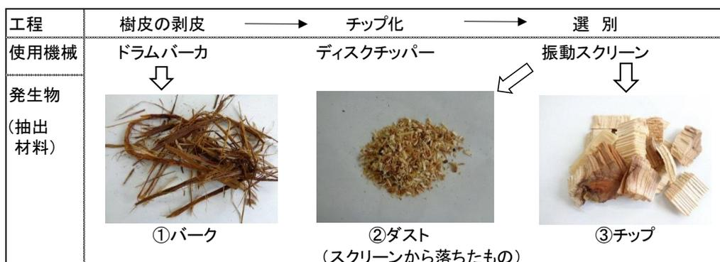
図1 木材チップの製造工程と抽出材料の発生フロー
