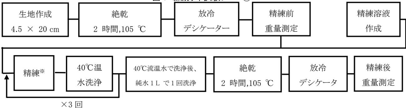
※ 精練溶液(表 1)220mL を使用し、温度 100℃、10 分間の精練を実施した。なお、精練中は試験溶液を 2 Mot(ホットマグネットスターラーのメーカー独自の回転数の値)の速さでスターラーかく拌した。
