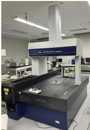
図2 高精度 CNC 三次元測定機
