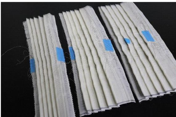
図5 静電容量センサとなるプリーツ構造の織物
