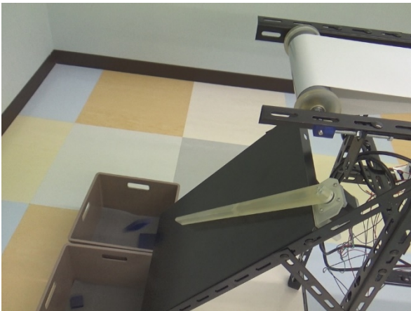
図6 稼働したアームと選別の様子
