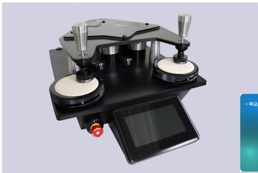
京都府では府内織物事業者の海外インテリア市場への販路開拓を支援しており、椅子やソファ等張り地にはマーチンデール摩耗試験による評価がよく求められるため、織物・機械金属振興センターに試験機を導入しました。（試験の説明は次頁のとおり）
