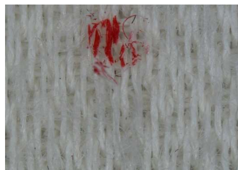
図3 たて糸の浮きが多い面の全体的な摩耗
