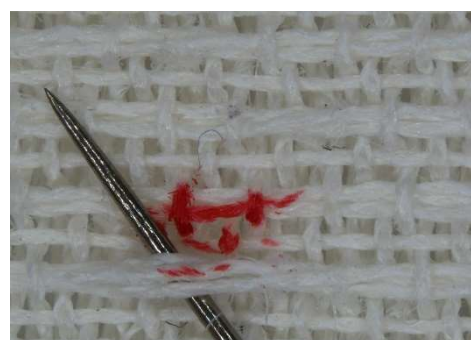
図4 たて糸の浮きが少ない面の糸切れ
