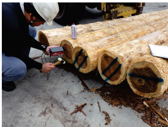
丸太の強度測定とマーキングの様子 (丸太を叩いた時の振動をから推定した強度をもとに、木口に強度区分を記載し、選別します)
