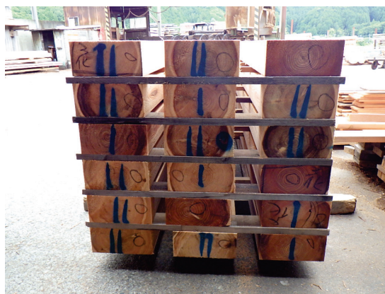
強度選別した丸太の製材 (製材・乾燥後にJAS格付を行い、結果を確認します)
