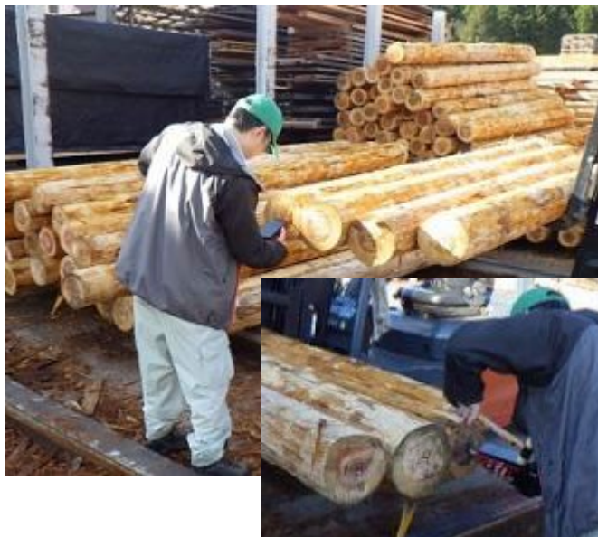
丸太の強度測定の様子 (丸太を叩いた時の固有振動数を スマホで計測し、強度を推定します)
