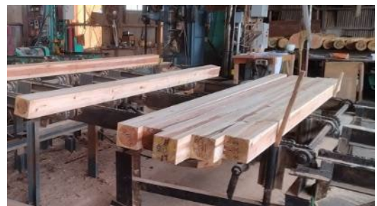
製材(一次加工)の様子 (今後、乾燥・仕上げ加工を経て、製材品段階の強度を測定します)
