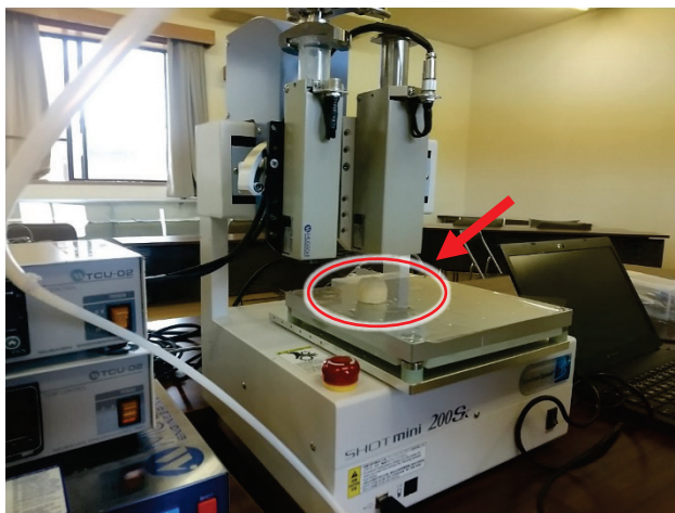
フード3Dプリンタ(M社製) パソコンの3Dデータに基づき台上に成型する(矢印)
