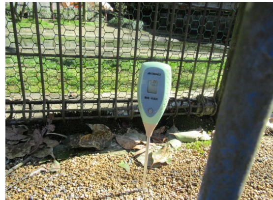
効果の持続性に影響を及ぼす散布土壌のpHを測定
