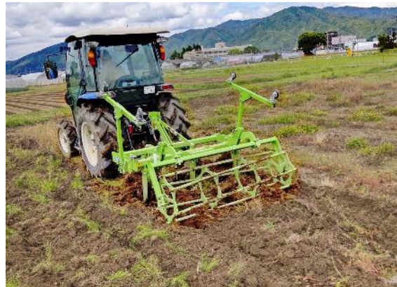
トラクタでチゼルプラウを牽引し、 耕起を行っている様子 (農林センターほ場)
