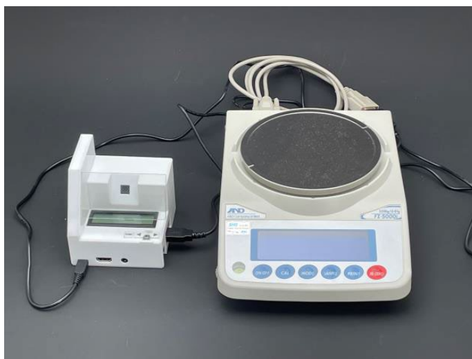
薬品管理システムの外観：センサー端末部(左)と電子天秤(右) (センサー端末部の制作費：15,000円)
