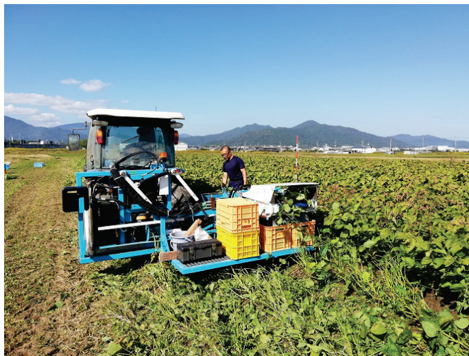
トラクタアタッチ式脱莢収穫機による黒大豆エダマメ収穫の作業性を調査
