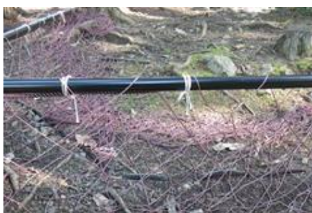
写真3 井桁状に組んだ方形枠(部分)。 グラス/カーボン/グラスファイバー 7m(2m×2+3m×1 外径41mm) 4本
