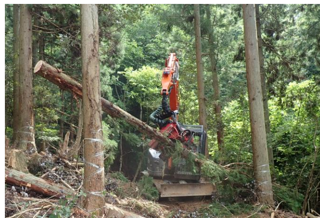
高性能林業機械を用いた施業の様子 (ハーベスタによる造材)
