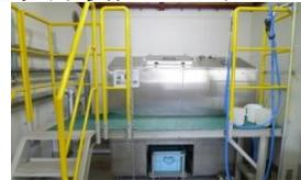
毎日、約180kgの菓子が真空乾燥施設で処理され、60kgの飼料原料が製造されています。(毎日180kg程度の廃棄物を削減)
