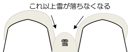
ハウスの屋根から落下した雪が積み重なり、屋根の雪とつながると、屋根の雪が落ちなくなります。
